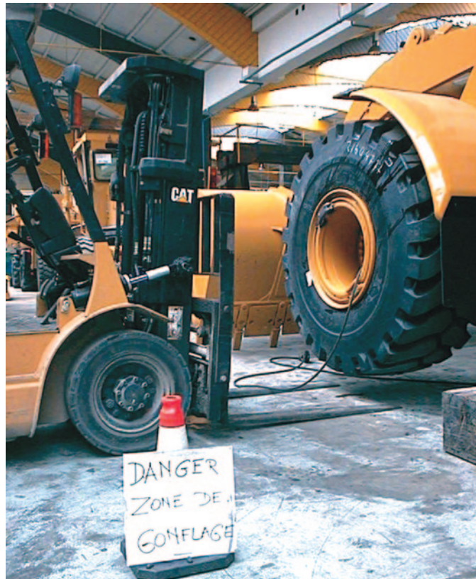
Inflado en posición vertical, entorno protegido en caso de proyección de piezas móviles
