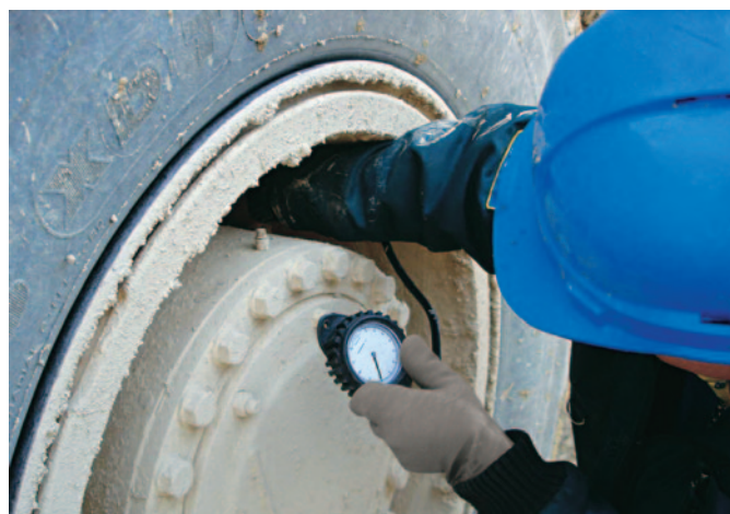
La presión en frío debe respetar la recomendación de diferencia máxima +/- 10 %
