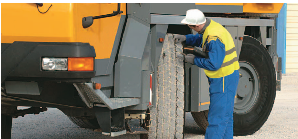
Comenzar por la posición delantera izquierda y después proceder alrededor del vehículo en el sentido de las manecillas de un reloj
