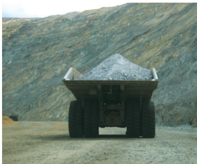
Un carga no bien estibada (no centrada) provoca una sobrecarga lateral puntual
