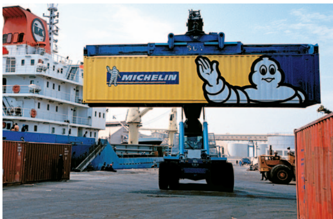
Grúa horquilla (carretilla elevadora) con mástil telescópico
