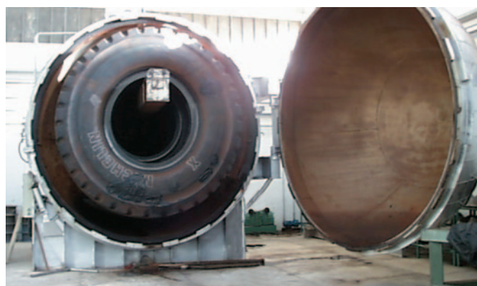
Vulcanización en autoclave
