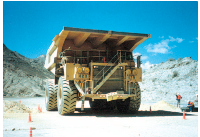
Los dos examinadores se ubican a un costado, el vehículo puede ser liberado
