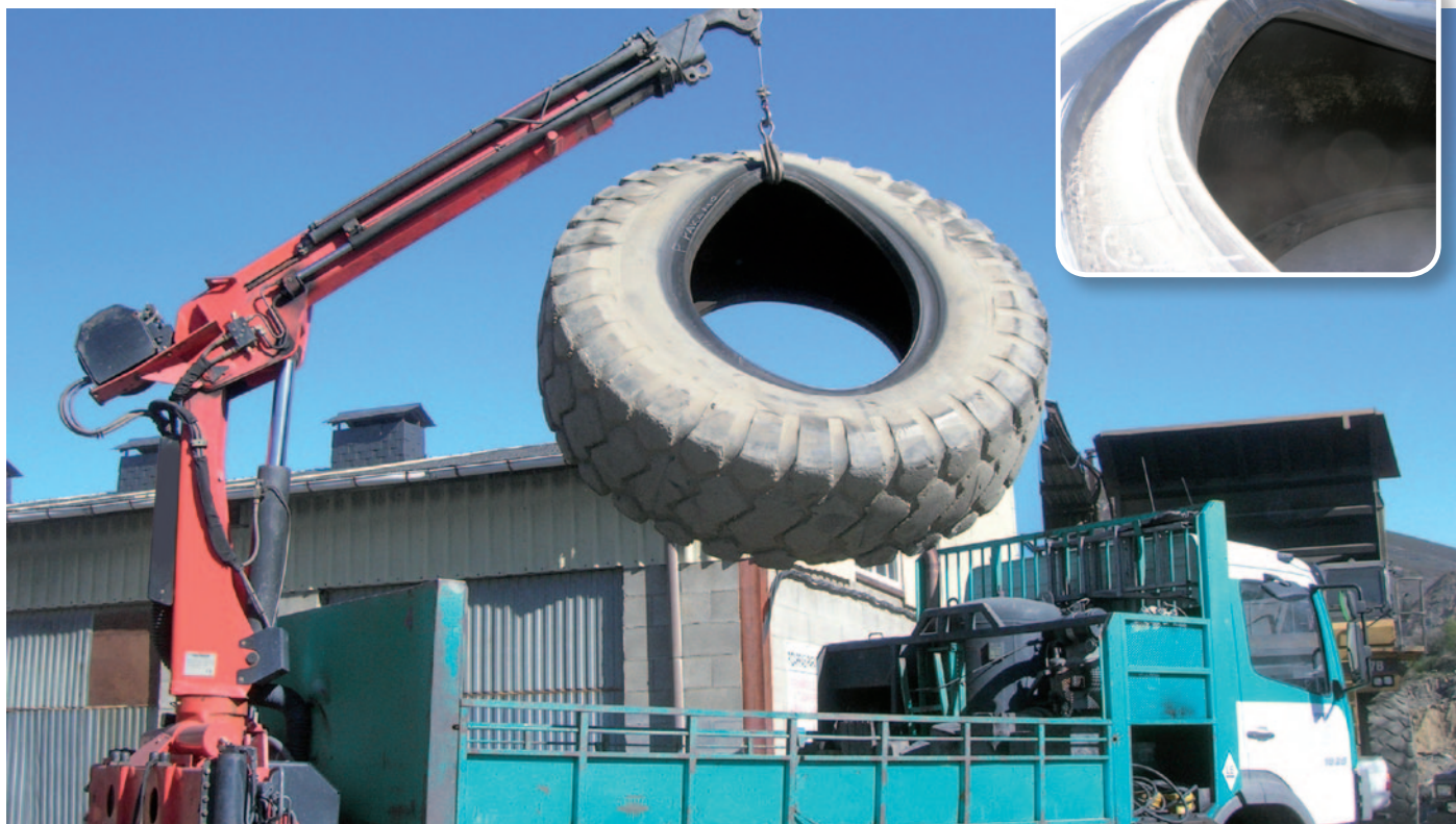
Una manipulación inadecuada puede causar daños irreparables
