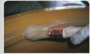
4 Lubricar el bisel o chafán del anillo cónico (aro cuchillo)
