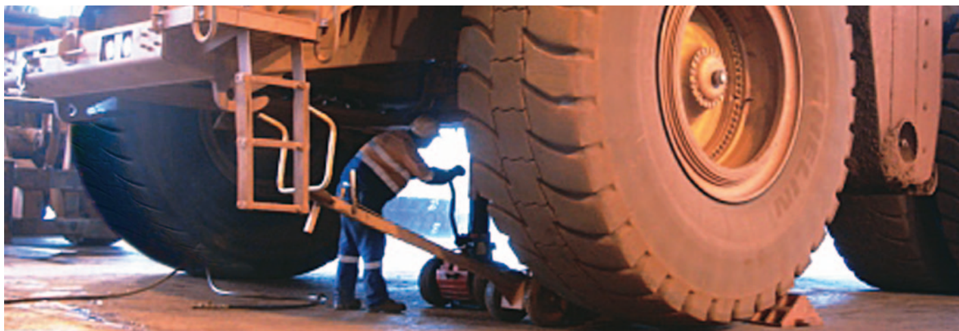
Para ajustar las suspensiones, se requiere asegurar el vehículo con cuñas (calzos)
