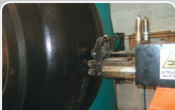
Revestimiento con una banda estrecha enrollada
