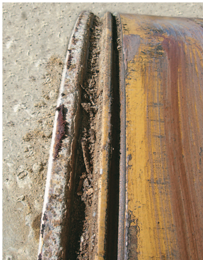
Limpiar las piezas que constituyen el aro (llanta, rin)
