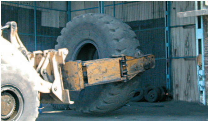
Cargadora equipada con un brazo manipulador de neumáticos o pinza para neumáticos ("tire handler")
