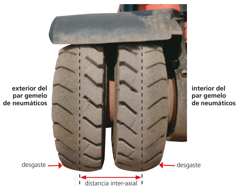
Desgaste en cono de un par de neumáticos
