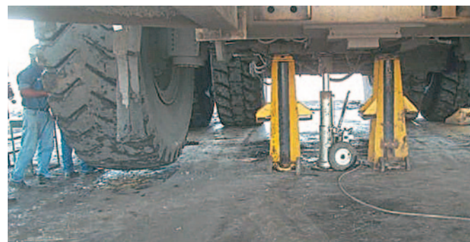
Se ajusta el paralelismo con las ruedas suspendidas
