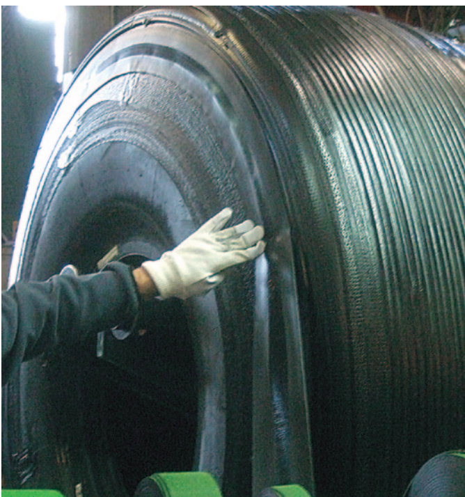
Colocación de bandas de poco espesor a enrollar
