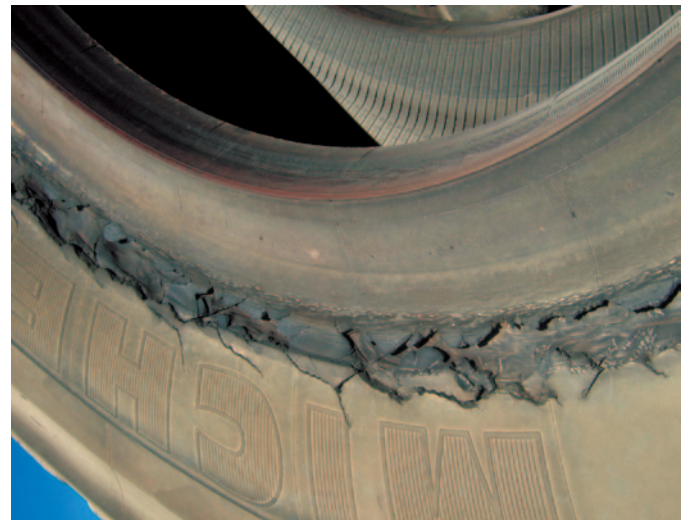
Daño en la zona del talón a causa de una sobrecarga del vehículo
