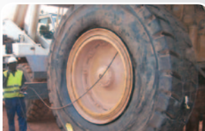
13 Inflar a la presión de montaje y después ajustar a la presión de trabajo
