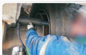
5 Empujar la pestaña (flange) del lado del chasis
