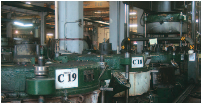
Vulcanización en una prensa
