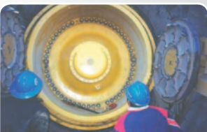
9 Empujar el anillo cónico (aro cuchillo) con el brazo manipulador o pinza de neumáticos
