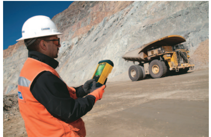
Con MEMS es posible verificar a distancia la presión de los neumáticos sin tener que detener las máquinas
