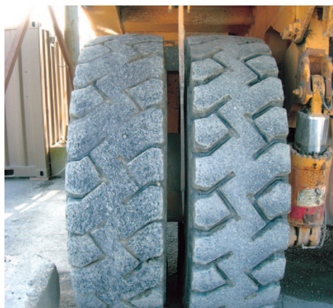
En un par gemelo, no montar neumáticos con desgastes diferentes
