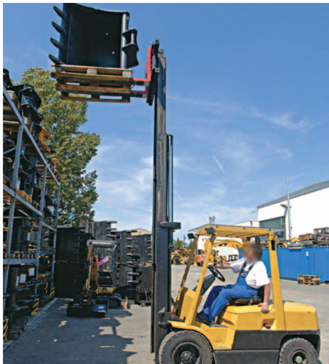
Insertos y sólidos mejoran la estabilidad de la máquina, a condición de respetar las precauciones normales de uso del vehículo
