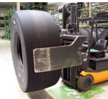
Un apriete excesivo puede deformar el neumático
