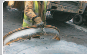
3 Lubricar la zona cónica del anillo cónico (aro cuchillo), la que queda en contacto con el talón del neumático
