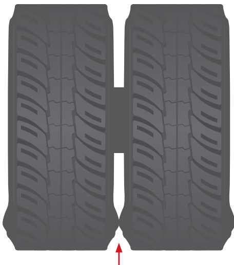
Contacto entre los flancos interiores ("kissing") de un par de neumáticos MICHELIN XDR2
