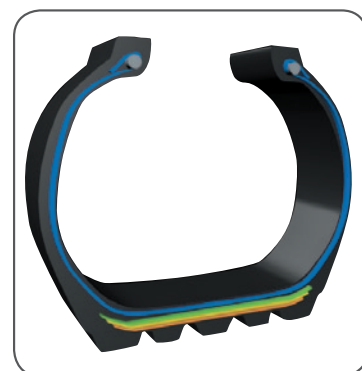
La estructura radial permite disociar el trabajo de la cima con el de los flancos
