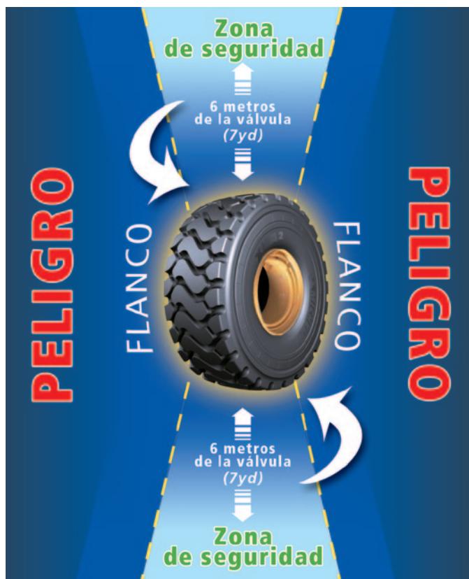
Durante el inflado, mantenerse siempre frente a la banda de rodamiento
