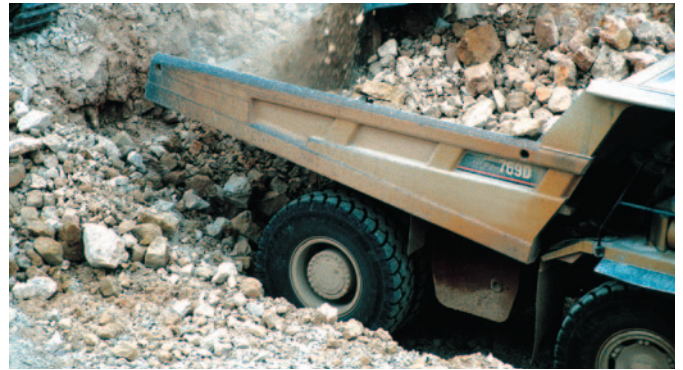
Las superficies pedregosas favorecen los arrancamientos o desgarros de los panes de goma
