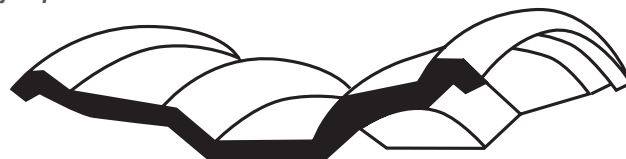
Aro (llanta, rin) con asentamiento a 15°
