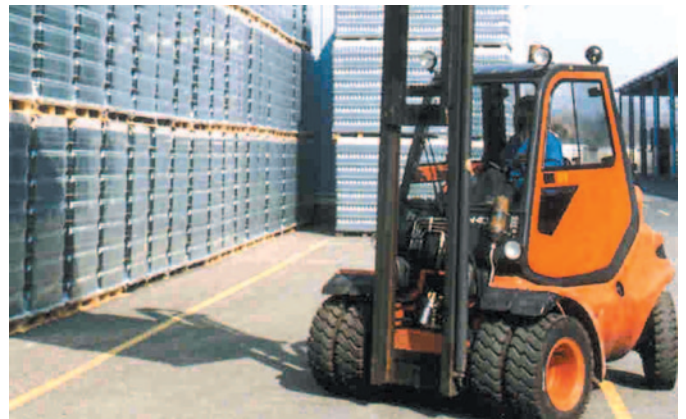
Carretilla elevadora (montacargas) equipada con neumáticos gemelos
