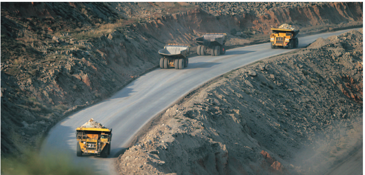
Los ciclos largos aumentan los riesgos de sobrecalentamiento (en comparación a aquellos con carga y velocidad similares pero más cortos)
