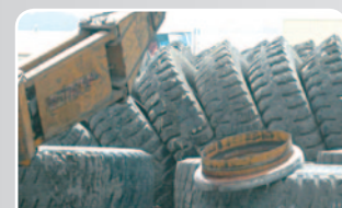
8 Retirar el anillo cónico (aro cuchillo) y la pestaña (flange)
