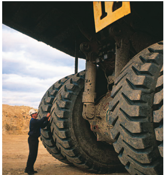
Asegurarse que no haya objetos bloqueados entre los dos neumáticos gemelos
