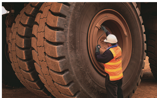
Antes de verificar la presión, limpiar la válvula
