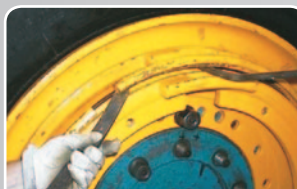
3 Extraer el anillo seguro (de cierre, de bloqueo)
