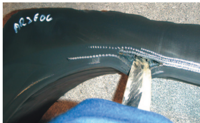
Separación de los componentes en un neumático
