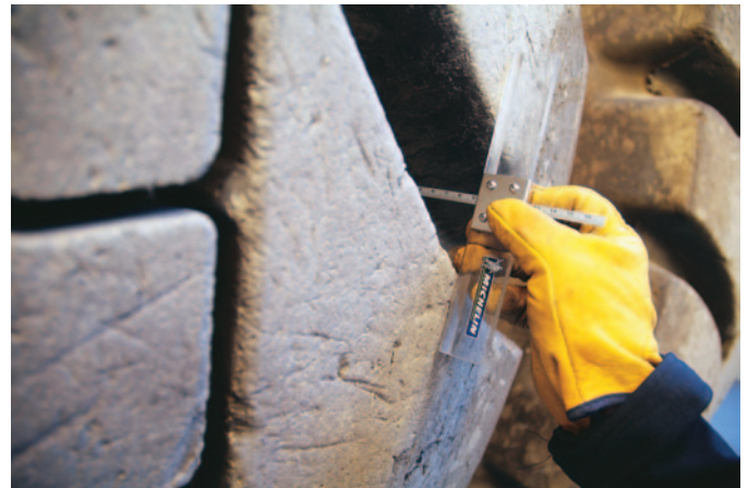
Medir la profundidad de escultura (goma remanente) en los puntos indicados en la cima y en varios sectores de la circunferencia.
