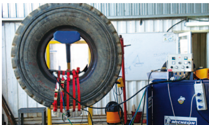
Vulcanización mediante prensa sectorial
