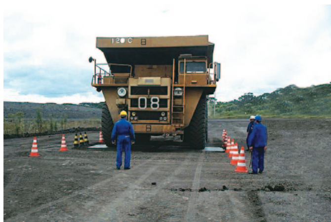
Pesaje de un camión dumper rígido (volquete rígido)
