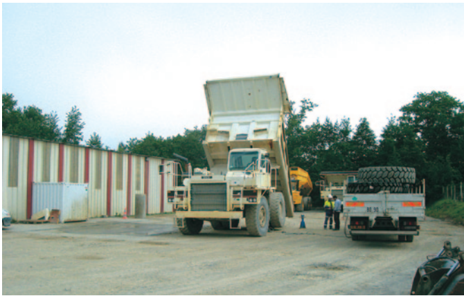
Máquinas estacionadas en un superficie plana, despejada, estabilizada y limpia
