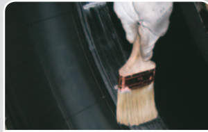
2 Lubricar la base de los talones del neumático
