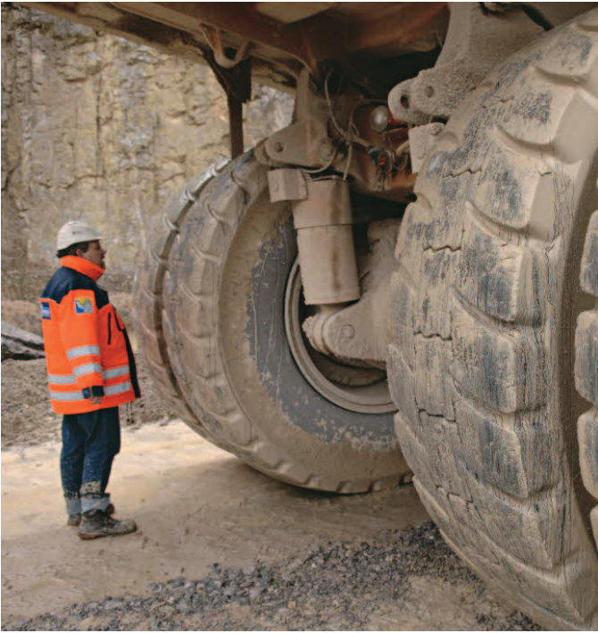
La inspección periódica de los pares de neumáticos es una obligación
