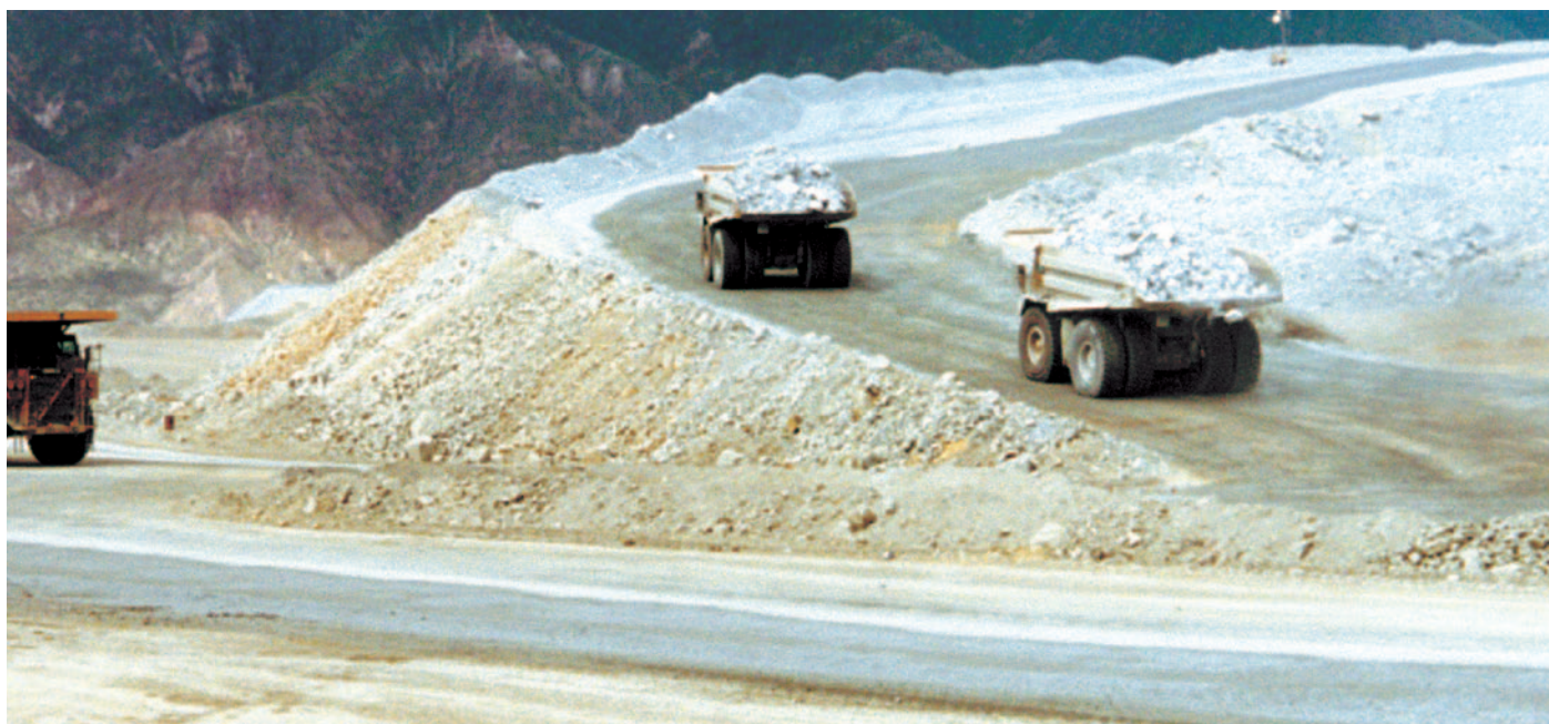
Curvas con poca inclinación toleran sólo velocidades reducidas.
