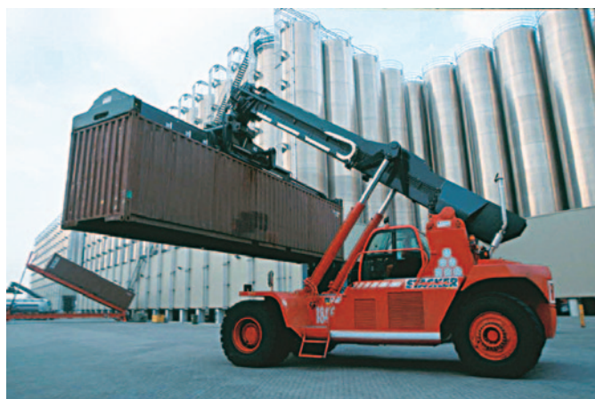
En los reach stacker, las ruedas directrices (traseras) son las más solicitadas, incluso cuando están cargados
