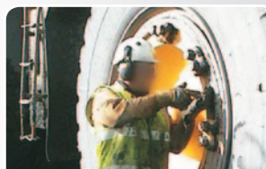
1 Retirar la tapa y el obús (pieza interna superior) de la válvula para desinflar completamente
