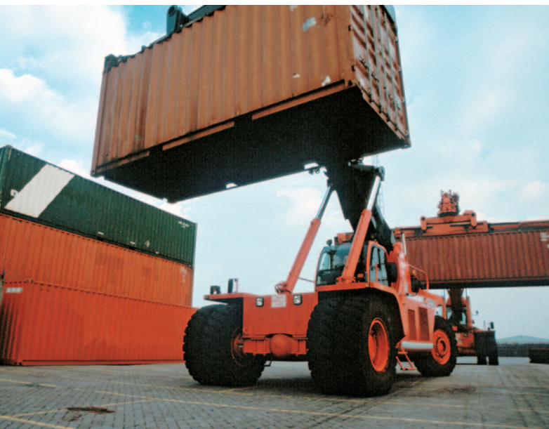
Se utiliza las neumáticos gemelos para máquinas que transportan cargas pesadas
